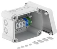
Kabelabzweigkasten zum Verbinden von Kabeln und Leitungen im Innen- und Außenbereich. Rechteckige Form mit Ausschlageinführungen. Geeignet für die Wand-/ Deckenmontage mit der Möglichkeit zur Außenbefestigung, Innenbefestigung oder Montage über die Eckdome. Besonders schlagfest mit IK09. Deckel mit Schnellverschluss, plombierbar. Hergestellt aus halogenfreien und UV-resistenten Materialien.
