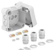
Kabelabzweigkasten mit Klemme zum Verbinden von Kabeln und Leitungen im Innen- und Außenbereich. Quadratische Form mit Ausschlageführungen. Geeignet für die Wand-/ Deckenmontage mit der Möglichkeit zur Außenbefestigung, Innenbefestigung oder Montage über die Eckdome. Besonders schlagfest mit IK09. Deckel mit Schnellverschluss, plombierbar. Hergestellt aus halogenfreien und UV-resistenten Materialien.
