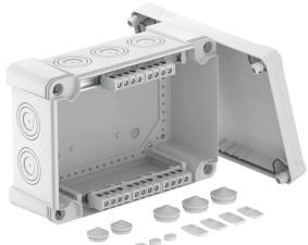
Kabelabzweigkasten mit Klemmleiste zum Verbinden von Kabeln und Leitungen im Innen- und Außenbereich. Rechteckige Form mit Ausschlageinführungen. Geeignet für die Wand-/ Deckenmontage mit der Möglichkeit zur Außenbefestigung, Innenbefestigung oder Montage über die Eckdome. Besonders schlagfest mit IK09. Deckel mit Schnellverschluss, plombierbar. Hergestellt aus halogenfreien und UV-resistenten Materialien.
