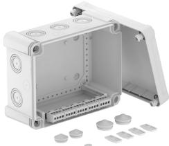
Kabelabzweigkasten mit Klemmleiste zum Verbinden von Kabeln und Leitungen im Innen- und Außenbereich. Rechteckige Form mit Ausschlageinführungen. Geeignet für die Wand-/ Deckenmontage mit der Möglichkeit zur Außenbefestigung, Innenbefestigung oder Montage über die Eckdome. Besonders schlagfest mit IK09. Deckel mit Schnellverschluss, plombierbar. Hergestellt aus halogenfreien und UV-resistenten Materialien. Inklusive Klemme.
