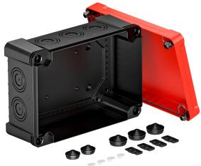
Kabelabzweigkasten zum Verbinden von Kabeln und Leitungen im Innen- und Außenbereich. Rechteckige Form mit Ausschlageinführungen. Geeignet für die Wand-/ Deckenmontage mit der Möglichkeit zur Außenbefestigung, Innenbefestigung oder Montage über die Eckdome. Besonders schlagfest mit IK09. Deckel mit Schnellverschluss, plombierbar. Hergestellt aus halogenfreien und UV-resistenten Materialien.
