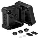
Kabelabzweigkasten zum Verbinden von Kabeln und Leitungen im Innen- und Außenbereich. Quadratische Form mit Ausschlageinführungen. Geeignet für die Wand-/ Deckenmontage mit der Möglichkeit zur Außenbefestigung, Innenbefestigung oder Montage über die Eckdome. Besonders schlagfest mit IK09. Deckel mit Schnellverschluss, plombierbar. Hergestellt aus halogenfreien und UV-resistenten Materialien.
