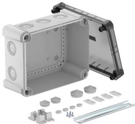
Kabelabzweigkasten mit Hutprofilschiene zum Verbinden von Kabeln und Leitungen im Innen- und Außenbereich. Rechteckige Form mit Ausschlageinführungen. Geeignet für die Wand-/ Deckenmontage mit der Möglichkeit zur Außenbefestigung, Innenbefestigung oder Montage über die Eckdome. Besonders schlagfest mit IK09. Transparenter Deckel mit Schnellverschluss, plombierbar. Hergestellt aus halogenfreien und UV-resistenten Materialien.
