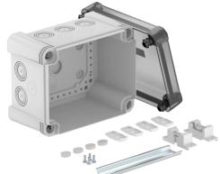
Kabelabzweigkasten mit Hutprofilschiene zum Verbinden von Kabeln und Leitungen im Innen- und Außenbereich. Rechteckige Form mit Ausschlageinführungen. Geeignet für die Wand-/ Deckenmontage mit der Möglichkeit zur Außenbefestigung, Innenbefestigung oder Montage über die Eckdome. Besonders schlagfest mit IK09. Transparenter Deckel mit Schnellverschluss, plombierbar. Hergestellt aus halogenfreien und UV-resistenten Materialien.
