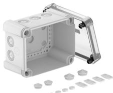
Kabelabzweigkasten zum Verbinden von Kabeln und Leitungen im Innen- und Außenbereich. Rechteckige Form mit Ausschlageinführungen. Geeignet für die Wand-/ Deckenmontage mit der Möglichkeit zur Außenbefestigung, Innenbefestigung oder Montage über die Eckdome. Besonders schlagfest mit IK09. Transparenter Deckel mit Schnellverschluss, plombierbar. Hergestellt aus halogenfreien und UV-resistenten Materialien.
