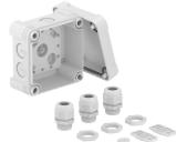
Kabelabzweigkasten zum Verbinden von Kabeln und Leitungen im Innen- und Außenbereich. Quadratische Form mit Ausschlageinführungen. Geeignet für die Wand-/ Deckenmontage mit der Möglichkeit zur Außenbefestigung, Innenbefestigung oder Montage über die Eckdome. Besonders schlagfest mit IK09. Deckel mit Schnellverschluss, plombierbar. Hergestellt aus halogenfreien und UV-resistenten Materialien.
