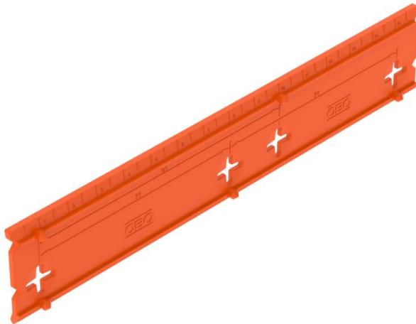
Bohrsabblone für Unterputz- und Hohlwanddosen. Zum Anzeichnen der Befestigungsabstände von 71 oder 91 mm. Mit Markierungshilfen zum Vorkörnen und mit Kerben zum Ausrichten an z. B. Schlagsschnurmarkierungen.
