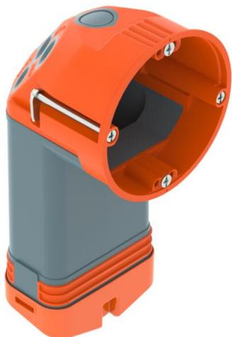
Hohlwand-Elektronikdose mit Membraneinführungen und zusätzlichem Verdrahtungsraum, für den Einsatz in Hohlwänden mit einer Einbautiefe von mindestens 75 mm und einer Plattenstärke von 5 - 35 mm.
