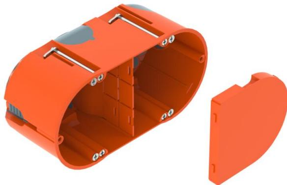
Hohlwand-Elektronikdose mit Membraneinführungen, Deckel und Trennwand, für den Einsatz in Hohlwänden mit einer Einbautiefe von mindestens 61 mm und einer Plattenstärke von 5 - 40 mm.
