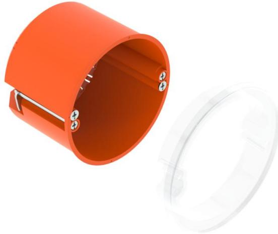
CEE/PERILEX-Hohlwand-Gerätedose mit Dichtring, für den Einsatz in Hohlwänden mit einer Einbautiefe von mindestens 61 mm und einer Plattenstärke von 5 - 40 mm.
