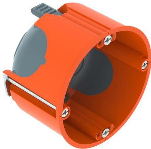
Hohlwand-Gerätedose mit luftdichten Membraneinführungen, für den Einsatz in Hohlwänden mit einer Einbautiefe von mindestens 47 mm und einer Plattenstärke von 5 - 40 mm.
