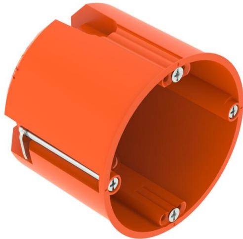
Hohlwand-Gerätedose für den Einsatz in Hohlwänden mit einer Einbautiefe von mindestens 61 mm und einer Plattenstärke von 5 - 40 mm.
