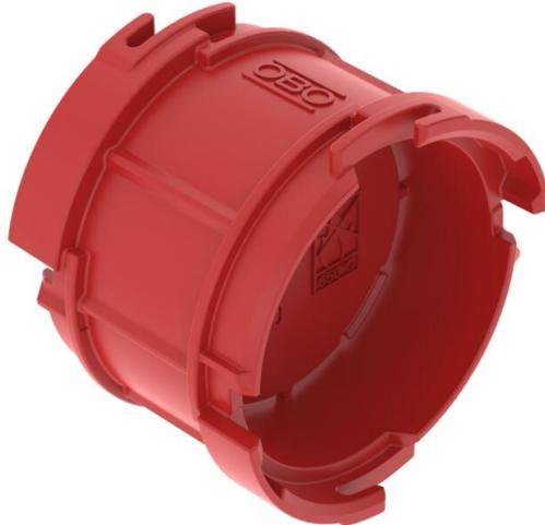
Abstandstutzen mit Bajonettverschluss für die stabile Kombination mehrerer Unterputz-Gerätedosen. Zur Erweiterung des Norm-Mittenabstands 71 mm um jeweils 20 mm.
