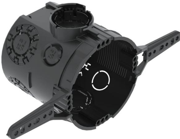
Unterputz-Gerätedose mit Nagellaschen, für den Einsatz in Mauerwerk mit einer Einbautiefe von mindestens 66 mm.
