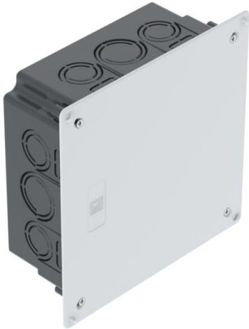
Unterputz-Verbindungskasten für das Verklemmen von Klemmen, Einsatz in Mauerwerk mit einer Einbautiefe von mindestens 65 mm. Mit Deckel und Deckelschrauben (15 mm). Plan aufliegender Deckelrand, aufgerauta Deckeloberfläche.
