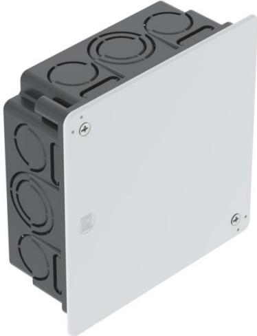
Unterputz-Verbindungskasten für das Verklemmen von Klemmen, Einsatz in Mauerwerk mit einer Einbautiefe von mindestens 45 mm. Mit Deckel und Deckelschrauben (15 mm). Plan aufliegender Deckelrand, aufgerauta Deckeloberfläche.
