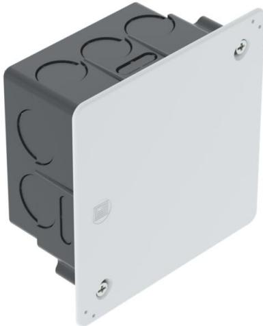
Unterputz-Verbindungskasten für das Verklemmen von Klemmen, Einsatz in Mauerwerk mit einer Einbautiefe von mindestens 45 mm. Mit Deckel und Deckelschrauben (15 mm). Plan aufliegender Deckelrand, aufgerauter Deckeloberfläche.
