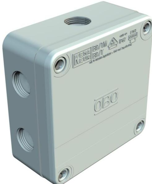
Der Kabelabzweigkasten B9/T... besteht aus zwei verschiedenen halogenfreien Kunststoffkomponenten. Er hat 8 Gewindegänge mit Durchstoßmembranen (7 x M20 seitlich und 1 x PG16 im Boden) sowie eine Membraneinführung im Boden für Kabeldurchmesser bis 15 mm.
