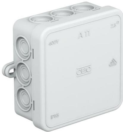
Schutzart IP55, Nennspannung 690 V, Nennquerschnitt 2,5 mm<sup>2</sup>, 12 Einführungen für Kabdurchmesser 5-14 mm.
