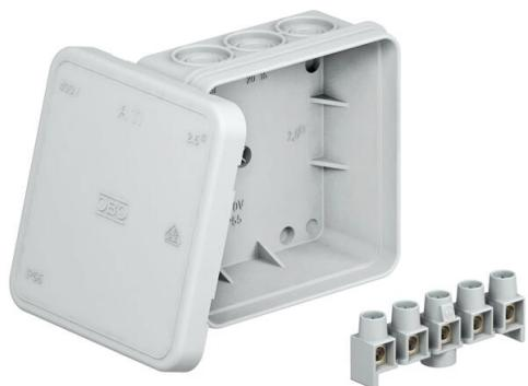
Schutzart IP55, Nennspannung 690 V, Nennquerschnitt 2,5 mm<sup>2</sup>, 12 Einführungen für Kabeldurchmesser 5-14 mm.
