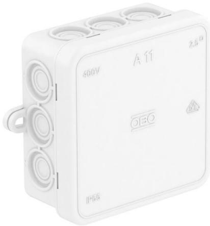
Schutzart IP55, Nennspannung 690 V, Nennquerschnitt 2,5 mm<sup>2</sup>, 12 Einführungen für Kabdeldurchmesser 5-14 mm.
