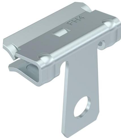
Trägerklammer mit Bohrung für individuelle Montagelösungen, z. B. für die Aufnahme von S-Haken oder Ketten. Befestigung an Stahträgern durch Aufschlagen.
