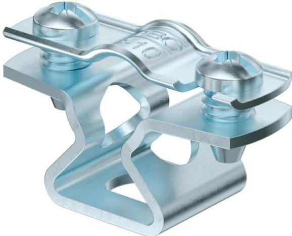
Abstandschelle zur Montage von Rohren und Kabeln an Wand, Decke und Boden. Mit selbstsicherndem Oberteil. Befestigung über Langloch.
