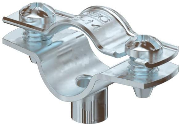
Abstandschelle zur Montage von Rohren und Kabeln an Wand, Decke und Boden. Mit selbstsicherndem Oberteil. Befestigung über Ansatz mit Innengewinde. Zugelassen für den Funktionserhalt nach DIN 4102 Teil 12, Funktionserhaltklassen E 30 bis E 90.
