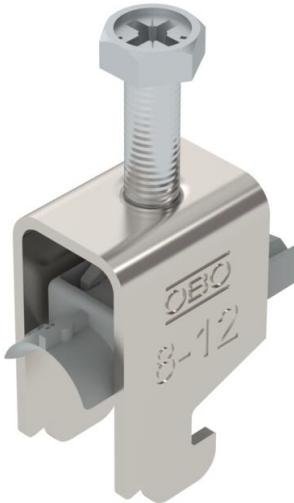
Bügelschelle mit N-Fuß, Kunststoffdruckwanne aus Polypropylen. Zur vertikalen und horizontalen Montage von 1 Einzelkabel an C-Profilschiene. Für Schlitzweite 11 - 12 mm. Mit 1-gängiger Schraube an Druckwanne, universeller Sechskantschraubekopf SW10, mit Schlitz und Kreuzschlitz. Geeignet für Montage im Innen- und Außenbereich. Der Einsatz einer Gegenwanne wird empfohlen.
