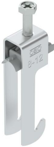
Bügelschelle mit W-Fuß, Kunststoffdruckwanne aus Polypropylen. Zur vertikalen und horizontalen Montage von 1 Einzelkabel an Winkelleisen mit 40 mm Schenkellänge. Mit 1-gängiger Schraube an Druckwanne, universeller Sechskantschraubenkopf SW10, mit Schlitz und Kreuzschlitz. Geeignet für Montage im Innen- und Außenbereich. Der Einsatz einer Gegenwanne wird empfohlen.
