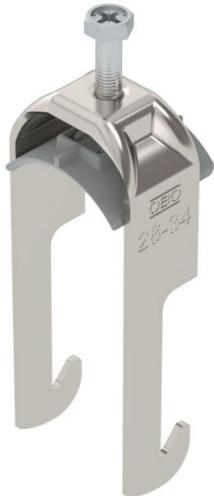
Bügelschelle mit W-Fuß, Kunststoffdruckwanne aus Polypropylen. Zur vertikalen und horizontalen Montage von 1 Einzelkabel an Winkelleisen mit 40 mm Schenkellänge. Mit 1-gängiger Schraube an Druckwanne, universeller Sechskantschraubekopf SW10, mit Schlitz und Kreuzschlitz. Geeignet für Montage im Innen- und Außenbereich. Der Einsatz einer Gegenwanne wird empfohlen.
