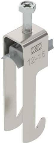
Bügelschelle mit W-Fuß, Kunststoffdruckwanne aus Polypropylen. Zur vertikalen und horizontalen Montage von 1 Einzelkabel an Winkelleisen mit 40 mm Schenkellänge. Mit 1-gängiger Schraube an Druckwanne, universeller Sechskantschraubekopf SW10, mit Schlitz und Kreuzschlitz. Geeignet für Montage im Innen- und Außenbereich. Der Einsatz einer Gegenwanne wird empfohlen.
