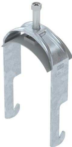
Bügelschelle mit W-Fuß, Kunststoffdruckwanne aus Polypropylen. Zur vertikalen und horizontalen Montage von 1 Einzelkabel an Winkeleisen mit 40 mm Schenkellänge. Mit 1-gängiger Schraube an Druckwanne, universeller Sechskantschraubenkopf SW10, mit Schlitz und Kreuzschlitz. Geeignet für Montage im Innen- und Außenbereich. Der Einsatz einer Gegenwanne wird empfohlen.
