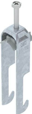
Bügelschelle mit W-Fuß, Kunststoffdruckwanne aus Polypropylen. Zur vertikalen und horizontalen Montage von 2 Einzelkabeln an Winkeleisen mit 40 mm Schenkellänge. Mit 1-gängiger Schraube an Druckwanne, universeller Sechskantschraubenkopf SW10, mit Schlitz und Kreuzschlitz. Geeignet für Montage im Innen- und Außenbereich. Mehrere Kabel sollten durch Doppelwannen getrennt werden. Der Einsatz einer Gegenwanne wird empfohlen.
