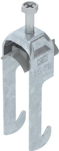
Bügelschelle mit W-Fuß, Kunststoffdruckwanne aus Polypropylen. Zur vertikalen und horizontalen Montage von 1 Einzelkabel an Winkelleisen mit 40 mm Schenkellänge. Mit 1-gängiger Schraube an Druckwanne, universeller Sechskantschraubenkopf SW10, mit Schlitz und Kreuzschlitz. Geeignet für Montage im Innen- und Außenbereich. Der Einsatz einer Gegenwanne wird empfohlen.
