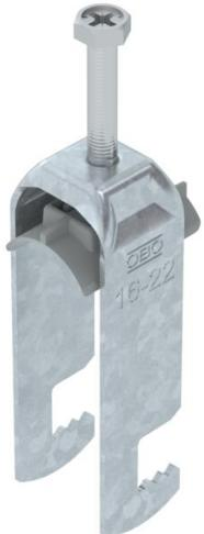
Bügelschelle mit F-Fuß, Kunststoffdruckwanne aus Polypropylen. Zur vertikalen und horizontalen Montage von 2 Einzelkabeln an Flacheisen. Mit 1-gängiger Schraube an Druckwanne, universeller Sechskant-Schraubenkopf SW10, mit Schlitz und Kreuzschlitz. Geeignet für Montage im Innen- und Außenbereich. Mehrere Kabel sollten durch Doppelwannen getrennt werden. Der Einsatz einer Gegenwanne wird empfohlen.
