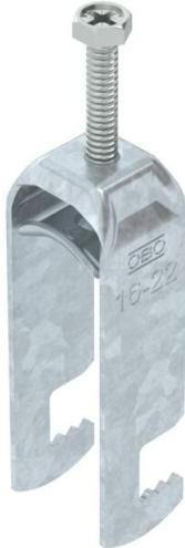
Bügelschelle mit F-Fuß, Metalldruckwanne mit gerundeten Kanten für Kabelschutz. Zur vertikalen und horizontalen Montage von 2 Einzelkabeln an Flacheisen. Mit 1-gängiger Schraube an Druckwanne, universeller Sechskant-Schraubkopf SW10, mit Schlitz und Kreuzschlitz. Geeignet für Montage im Innen- und Außenbereich. Mehrere Kabel sollten durch Doppelwannen getrennt werden. Der Einsatz einer Gegenwanne wird empfohlen.
