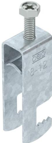
Bügelschelle mit F-Fuß, Metalldruckwanne mit gerundeten Kanten für Kabelschutz. Zur vertikalen und horizontalen Montage von 2 Einzelkabeln an Flacheisen. Mit 1-gängiger Schraube an Druckwanne, universeller Sechskant-Schraubkopf SW10, mit Schlitz und Kreuzschlitz. Geeignet für Montage im Innen- und Außenbereich. Mehrere Kabel sollten durch Doppelwannen getrennt werden. Der Einsatz einer Gegenwanne wird empfohlen.
