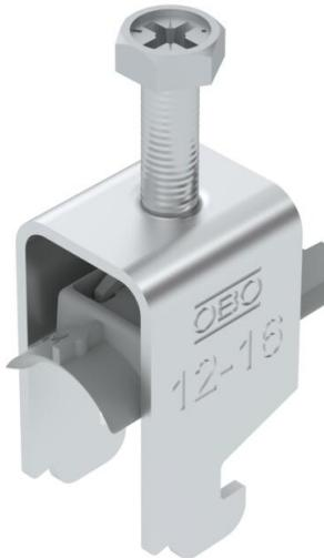
Bügelschelle mit N-Fuß, Kunststoffdruckwanne aus Polypropylen. Zur vertikalen und horizontalen Montage von 1 Einzelkabel an C-Profilschiene. Für Schlitzweite 11 - 12 mm. Mit 1-gängiger Schraube an Druckwanne, universeller Sechskantschraubenkopf SW10, mit Schlitz und Kreuzschlitz. Geeignet für Montage im Innen- und Außenbereich. Der Einsatz einer Gegenwanne wird empfohlen.
