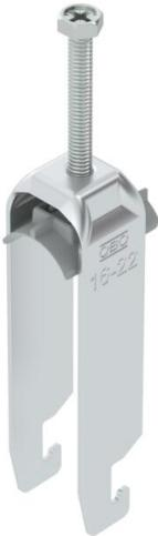
Bügelschelle mit U-Fuß, Kunststoffdruckwanne aus Polypropylen. Zur vertikalen und horizontalen Montage von 3 Einzelkabeln an C-Profilschiene. Für Schlitzweite 18 - 22 mm. Mit 1-gängiger Schraube an Druckwanne, universeller Sechskantschraubenkopf SW10, mit Schlitz und Kreuzschlitz. Geeignet für Montage im Innen- und Außenbereich. Mehrere Kabel sollten durch Doppelwannen getrennt werden. Der Einsatz einer Gegenwanne wird empfohlen.
