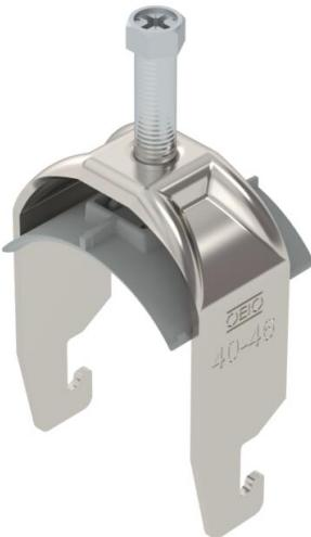
Bügelschelle mit U-Fuß, Kunststoffdruckwanne aus Polypropylen. Zur vertikalen und horizontalen Montage von 1 Einzelkabel an C-Profilschiene. Für Schlitzweite 18 - 22 mm. Mit 1-gängiger Schraube an Druckwanne, universeller Sechskantschraubekopf SW10, mit Schlitz und Kreuzschlitz. Geeignet für Montage im Innen- und Außenbereich. Der Einsatz einer Gegenwanne wird empfohlen.
