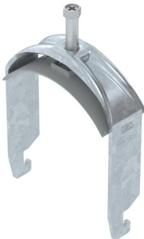
Bügelschelle mit U-Fuß, Kunststoffdruckwanne aus Polypropylen. Zur vertikalen und horizontalen Montage von 1 Einzelkabel an C-Profilschiene. Für Schlitzweite 18 - 22 mm. Mit 1-gängiger Schraube an Druckwanne, universeller Sechskantschraubekopf SW10, mit Schlitz und Kreuzschlitz. Geeignet für Montage im Innen- und Außenbereich. Der Einsatz einer Gegenwanne wird empfohlen.
