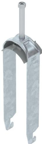
Bügelschelle mit U-Fuß, Kunststoffdruckwanne aus Polypropylen. Zur vertikalen und horizontalen Montage von 3 Einzelkabeln an C-Profilschiene. Für Schlitzweite 18 mm oder 22 mm. Mit 1-gängiger Schraube an Druckwanne, universeller Sechskant-Schraubenkopf SW10, mit Schlitz und Kreuzschlitz. Geeignet für Montage im Innen- und Außenbereich. Mehrere Kabel sollten durch Doppelwangen getrennt werden. Der Einsatz einer Gegenwanne wird empfohlen.
