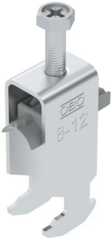
Bügelschelle mit Hammerkopf-Fuß, Kunststoffdruckwanne aus Polypropylen. Zur vertikalen und horizontalen Montage von 2 Einzelkabeln an C-Profilschiene. Für Schlitzweite 16 - 17 mm. Mit 1-gängiger Schraube an Druckwanne, universeller Sechskant-Schraubenkopf SW10, mit Schlitz und Kreuzschlitz. Geeignet für Montage im Innen- und Außenbereich. Mehrere Kabel sollten durch Doppelwangen getrennt werden. Der Einsatz einer Gegenwanne wird empfohlen.
