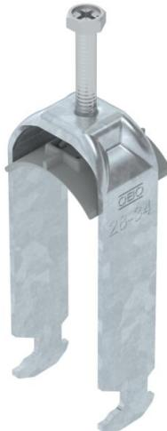
Bügelschelle mit Hammerkopf-Fuß, Kunststoffdruckwanne aus Polypropylen. Zur vertikalen und horizontalen Montage von 2 Einzelkabeln an C-Profilschiene. Für Schlitzweite 16 - 17 mm. Mit 1-gängiger Schraube an Druckwanne, universeller Sechskant-Schraubenkopf SW10, mit Schlitz und Kreuzschlitz. Geeignet für Montage im Innen- und Außenbereich. Mehrere Kabel sollten durch Doppelwangen getrennt werden. Der Einsatz einer Gegenwanne wird empfohlen.
