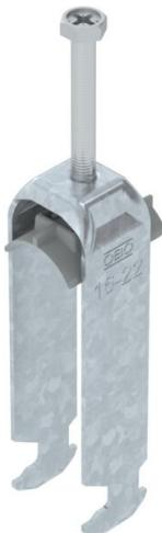
Bügelschelle mit Hammerkopf-Fuß, Kunststoffdruckwanne aus Polypropylen. Zur vertikalen und horizontalen Montage von 3 Einzelkabeln an C-Profilschiene. Für Schlitzweite 16 - 17 mm. Mit 1-gängiger Schraube an Druckwanne, universeller Sechskant-Schraubenkopf SW10, mit Schlitz und Kreuzschlitz. Geeignet für Montage im Innen- und Außenbereich. Mehrere Kabel sollten durch Doppelwanne getrennt werden. Der Einsatz einer Gegenwanne wird empfohlen.
