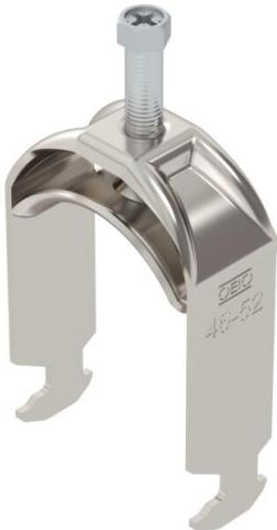
Bügelschelle mit Hammerkopf-Fuß, Metalldruckwanne mit gerundeten Kanten für Kabelschutz. Zur vertikalen und horizontalen Montage von 1 Einzelkabel an C-Profilsschiene. Für Schlitzweite 16 - 17 mm. Mit 1-gängiger Schraube an Druckwanne, universeller Sechskant-Schraubenkopf SW10, mit Schlitz und Kreuzschlitz. Geeignet für Montage im Innen- und Außenbereich. Der Einsatz einer Ge- genwanne wird empfohlen.
