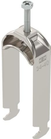
Bügelschelle mit Hammerkopf-Fuß, Metalldruckwanne mit gerundeten Kanten für Kabelschutz. Zur vertikalen und horizontalen Montage von 2 Einzelkabeln an C-Profilsschiene. Für Schlitzweite 16 - 17 mm. Mit 1-gängiger Schraube an Druckwanne, universeller Sechskant-Schraubenzapfen SW10, mit Schlitz und Kreuzschlitz. Geeignet für Montage im Innen- und Außenbereich. Mehrere Kabel sollten durch Doppelwannen getrennt werden. Der Einsatz einer Gegenwanne wird empfohlen.
