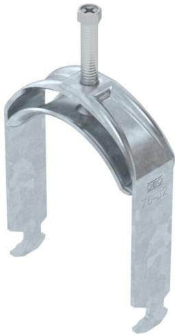
Bügelschelle mit Hammerkopf-Fuß, Metalldruckwanne mit gerundeten Kanten für Kabelschutz. Zur vertikalen und horizontalen Montage von 1 Einzelkabel an C-Profilschiene. Für Schlitzweite 16 - 17 mm. Mit 1-gängiger Schraube an Druckwanne, universeller Sechskant-Schraubenzapfen SW10, mit Schlitz und Kreuzschlitz. Geeignet für Montage im Innen- und Außenbereich. Gegenwanne muss separat bestellt werden.
