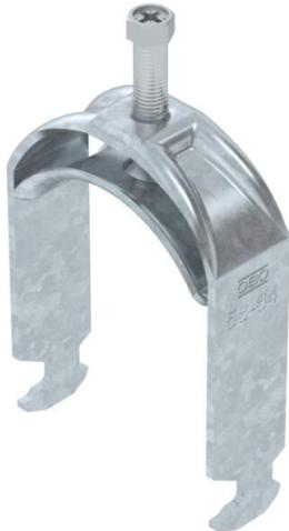
Bügelschelle mit Hammerkopf-Fuß, Metalldruckwanne mit gerundeten Kanten für Kabelschutz. Zur vertikalen und horizontalen Montage von 1 Einzelkabel an C-Profilsschiene. Für Schlitzweite 16 - 17 mm. Mit 1-gängiger Schraube an Druckwanne, universeller Sechskant-Schraubenkopf SW10, mit Schlitz und Kreuzschlitz. Geeignet für Montage im Innen- und Außenbereich. Gegenwanne muss separat bestellt werden.
